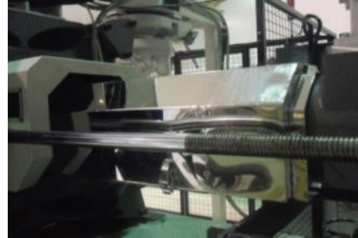
รูปที่ 3.2 การติดตั้งฉนวนกันความร้อนที่กระบอกฉีดพลาสติก
