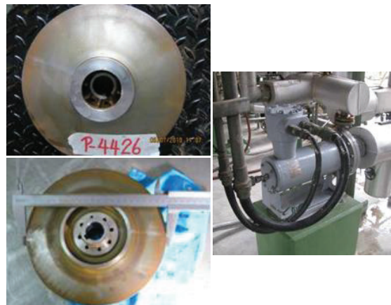
รูปที่ 15.4 ใบพัดเครื่องสูบน้ำก่อนและหลังดำเนินการเจียรเพื่อลดขนาดและการติดตั้งปั้มน้ำขนาด 11 kW (หลังดำเนินการเจียรลดขนาด)
